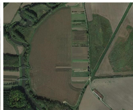
Obr. 1: Fádní zemědělská říční krajina – dočkáme se změn? Vlevo: protipovodňová hráz Svratky u Velkých Němcic chrání ornou půdu v nivě před záplavami do padesátileté vody a zároveň zvyšuje výšku hladiny při stoleté vodě v obci. Vpravo: na satelitním snímku je lán orné půdy určený v rámci návrhu přírodě blízkých protipovodňových opatření jako retenční prostor k transformaci povodňové vlny. Foto David Pithart
