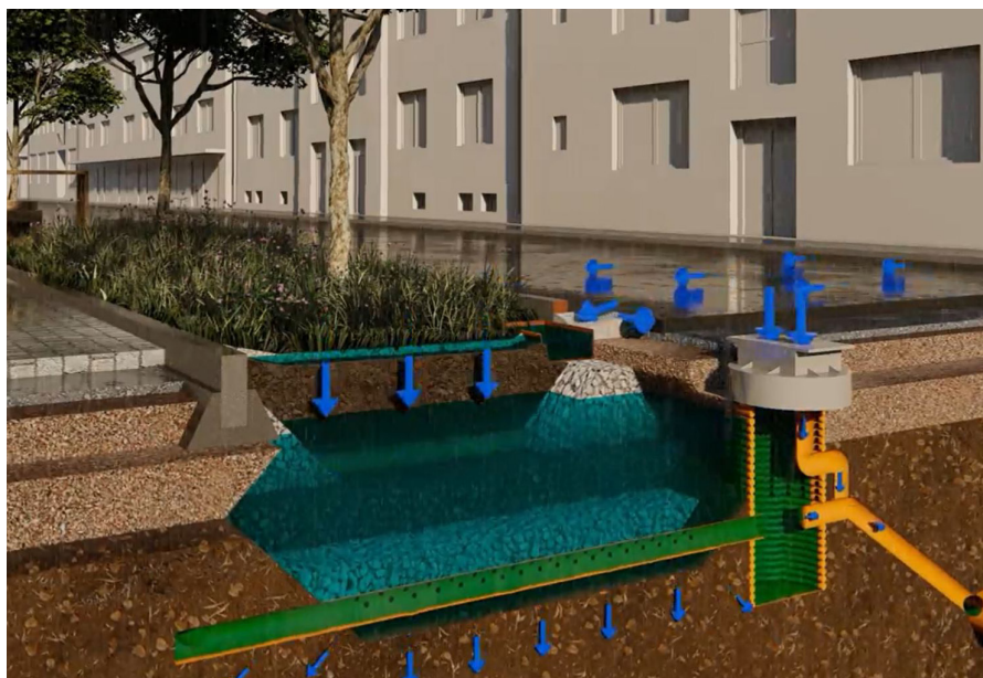
Obr. 6: Ilustrace ukazuje, jak BGG systém pracuje jak s lehkými, tak i extrémními srážkami. Na tomto příkladu, lze vidět bioretenční plochu, která je na otevřené podkladní vrstvě, jenž je napojena na šachtu s vpustí, která chytře reguluje dešťovou vodu. Bioretenční plocha plní nároky na zadržení a čištění lehkých dešťů. V případě méně častých extrémních dešťů, kdy je její zádržný prostor rychle naplněn, dešťová voda vteče do nejbližší šachty, která dešťovou vodu reguluje tak, aby voda vtekla pod povrch do druhého zádržného prostoru, který plní otevřená podkladní vrstva, jež je pod bioretenční plochou. Ilustrace: K2N Landscape, Lumiartsoft, edge, RISE
